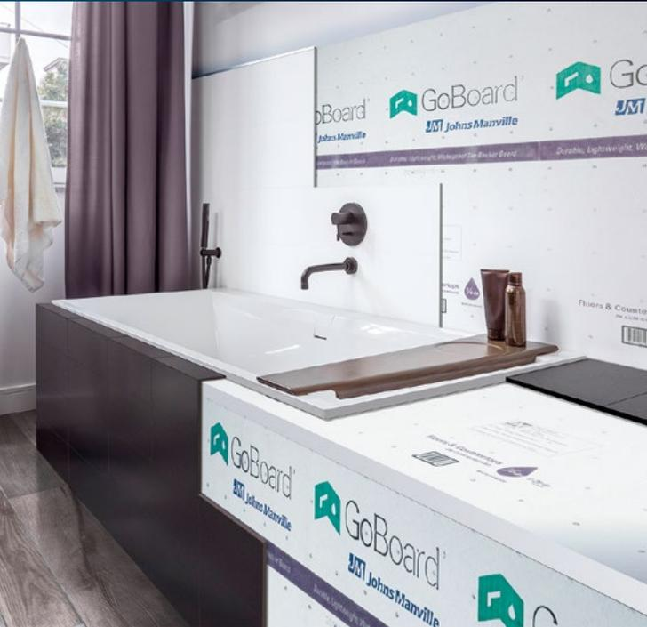
高密度聚異三聚氰酸脂泡沫板，兩側覆蓋有玻璃纖維增強的水泥基防水塗料，可鋪設瓷磚。經過長時間抗性測試的面板厚度為6,25 / 12,5 / 25和50 mm，尺寸為92 x 152 cm和122 x 244 cm，可用於地板，錯誤安裝的天花板，牆壁，淋浴和天花板。
